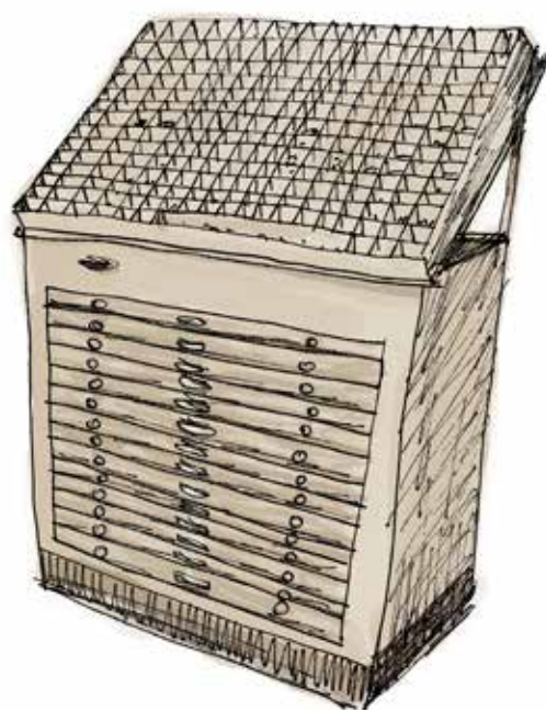
Armário em madeira para a composição tipográfica com gavetas de tipos. O tipógrafo retirava os tipos na sequência dos textos a imprimir e colocava-os num componedor, letra a letra, palavra a palavra, frase a frase, ordenados de direita para a esquerda, com as letras espelhadas.
